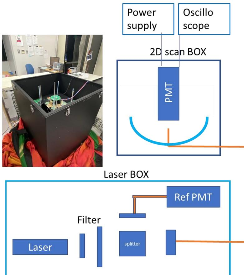
注) レーザ BOX を開けて作業するときには、レーザ電源を切る事。開けて作業が必要な時は、レーザ用のサングラスをつける事。
