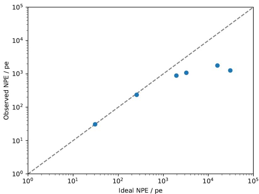
ただし、現状スプリッターで分離後レーザー光を光ファイバーで輸送してPMTに当てているのでロスが大きく固定1%付きのデータだけでは、十分な強度がでないので、1%付きと無のをつなぎあわせている。1%無で0.1%は飽和領域に入らないので、これを基準点とidealの量をもとめて、2つのデータを元に、一つの図を書かせる。
