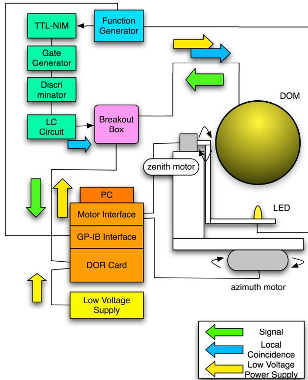
ここで、DOMの設置の仕方について述べる。DOMの向きは下である。上側の3本のワイヤーはアルミの金具で束ねる。下側の3本のワイヤーは上側に持ってきてひもなどでとめておく。上側の3本の先にあるわっかを、Black Boxの天井についているフックにかける。DOMの高さはフックについているねじにより調節する。DOMの高さは正確にセットしたいので、LEDを90°の位置に動かしLEDの光を当てて確かめる。
