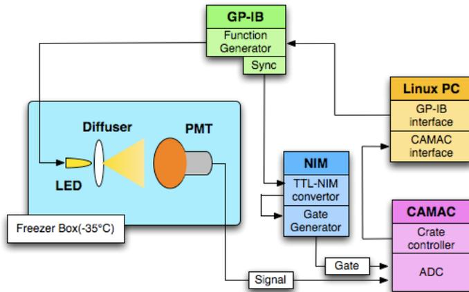
図のように回路を組み立てる。Gateは100ns、Function Generatorは2kHz。PMTをセットしてから少なくとも半日は待つ。
