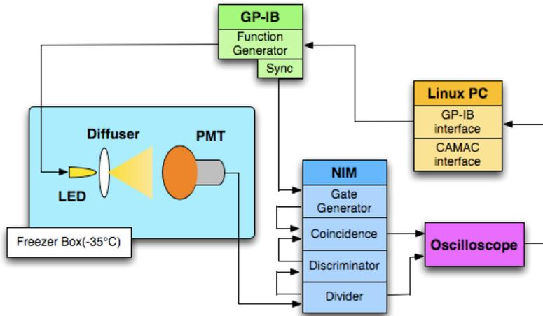
PMTからの信号はだいたい40mV程度。Discr Levelをだいたい17mVにし、オシロスコープのレンジは、SPE全体がとれるようにレンジを切り替える。
