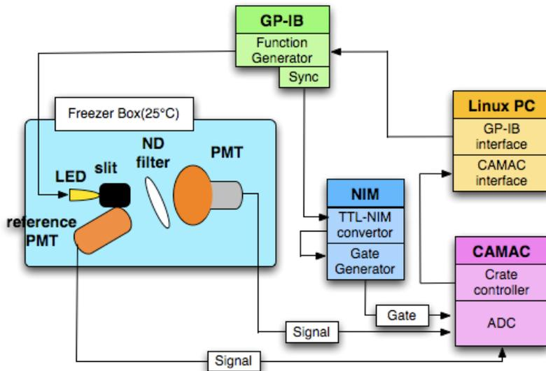
回路は上図のようになる。この測定では、QEの分かっている2 inch PMT(reference PMT)を使用する。また、ND filterの透過率と反射率を測定するときには、10 inch PMTとしてQEの分かっているものを置く。ND filterから各PMTまでの距離は約11cmである。CAMACでは、二つのPMTからの信号を同時に取得する。LEDはXステージにより移動可能である。
