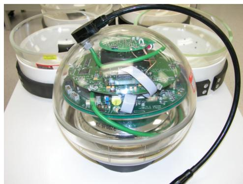
図 1: 左図に IceCube 観測装置の全体像を示した。深さ 1400m から 2400m の位置に計 4800 本の光検出器 (DOM) を埋め込む。右図は、光検出器 (DOM)。耐圧球の中に光電子増倍管、データ収集回路、電源、地磁気シールドなどが入っている。
