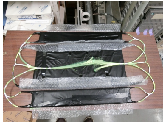
図 4. ベトーカー用のプラスチックシンチレータ
