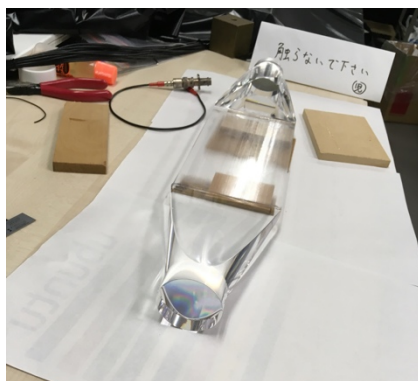
プラスチックシンチレータと両端のライトガイド接続
