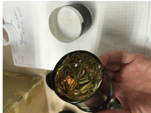
BGO と PMT の接続: 光学グリス
