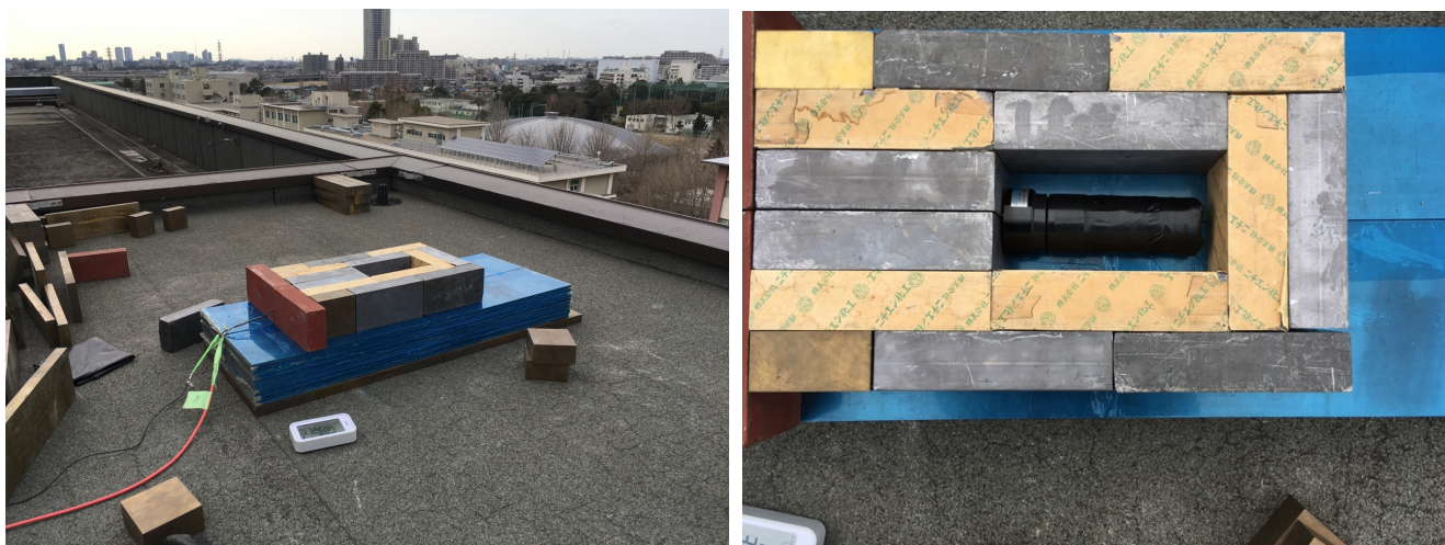
図 1. セットアップ 1 写真：鉛と真鍮で遮蔽された BGO 検出器
