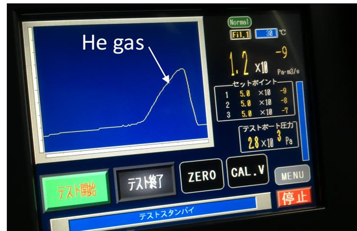
Heガススプレーを噴射してリークがあれば時間差で信号が確認できる。
