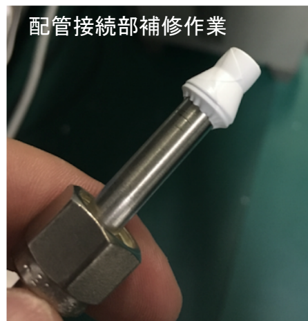
スエジ接続部先端にテフロンシートを巻いて固定した。
