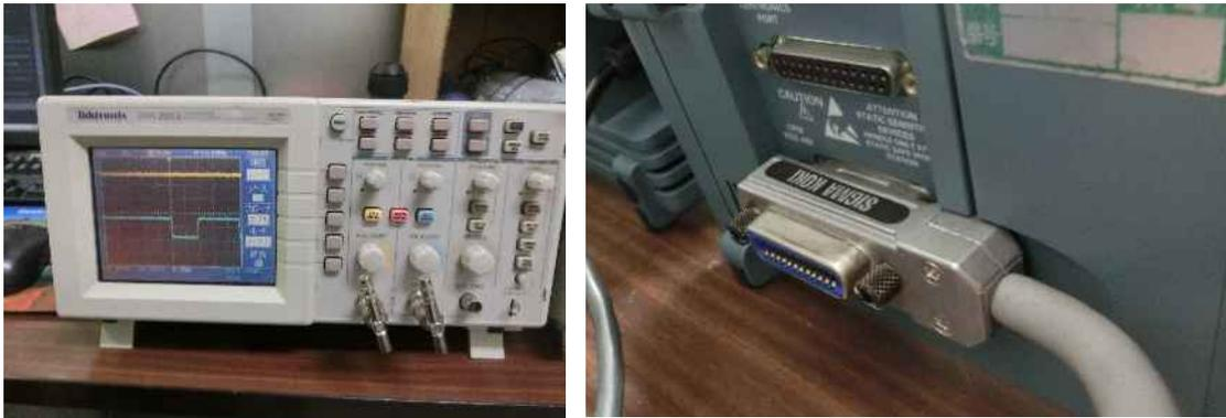
図 2. オシロスコープ Tektronix TDS2012。正面写真 (左)。背面写真 (右)
