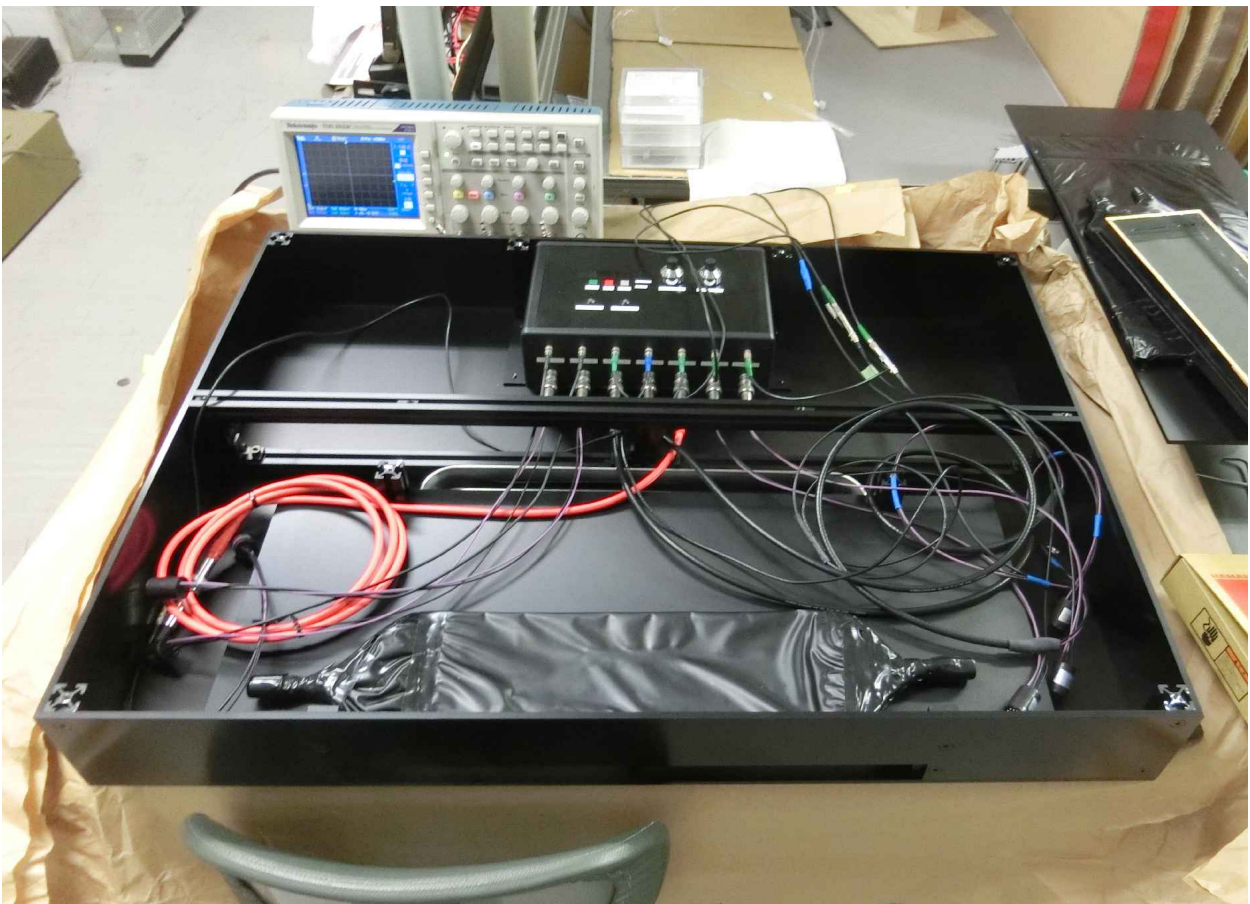
図 2. リアルタイムストロンチウム 90 カウンター初号機の配線作業途中写真: 中央奥の回路で PMT 電圧供給と信号処理、計数記録を行う。中央手前にカウンター本体(有効面積 300 \times 100 \text{ mm}^2 )が設置される。外側手前に引き出しが設置され、試料を設置される。
