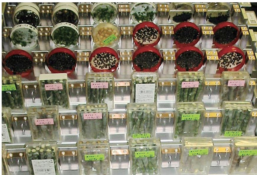
乾燥種子・吸水種子・培養体・培養細胞・穂木・挿し穂などの照射サンプルはそれぞれに適した試料容器に収め、その種類ごとに製作したカセットにセットし、カセットは自動試料交換装置のステージ上に設置する。写真カセットの照射試料は、手前3列はミカンの穂木、次の赤いテープを巻いたシャーレはベリーの吸水種子、奥の白いテープを巻いたシャーレはナシの培養体である。
