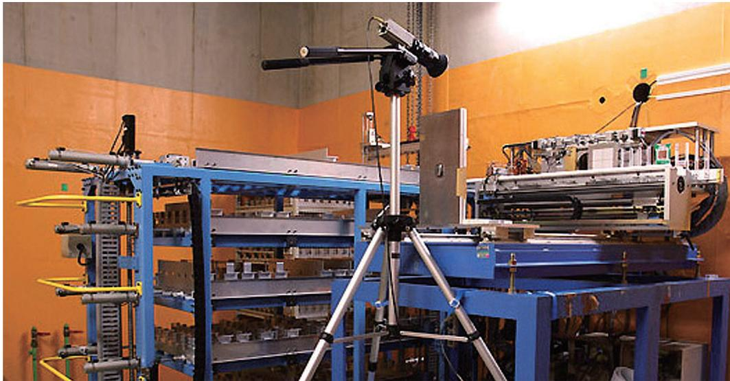
生物自動照射装置（自動試料交換装置と「レンジシフター」）。写真左の自動試料交換装置のステージ上に設置したカセットを順次取り出し、セットした試料を写真中央の照射ポイントに設置する。
