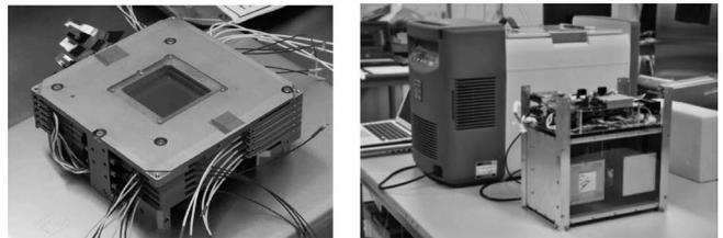
図3 試作した超広角コンプトンカメラの写真。(左) SiとCdTeのイメージャーをそれぞれ、2層と3層積み重ねた検出器。本カメラのために開発された読み出し用の低雑音多チャンネルLSIにはADCが組み込まれており、検出器の信号はデジタル信号に変換された上で出力される。(右) 冷却用の可搬型冷蔵庫と2台用意したコンプトンカメラ。冷蔵庫の外側に超広角レンズをつけた小型デジタルカメラを装着した。
