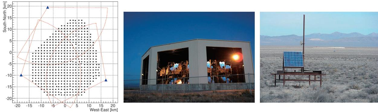
(左図) TA の検出器配置。四角印は地表検出器 (SD) を、3 カ所の三角印は FD (大気蛍光望遠鏡) ステーションを表す。各 FD の視野は図中の方位角方向  $108^\circ$  (図中下の 2 ステーション) と  $120^\circ$  (図中上のステーションのみ) の扇形で表されている。図では FD から 25 km の範囲を見渡すとした視野で描いてあるが、実際に観測可能な範囲は宇宙線のエネルギーに依存する。
