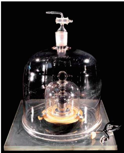
図1 国際キログラム原器(IPK)。写真提供：BIPM。白金89.9%、イリジウム10.1%から成る合金製の分銅。直径、高さともに約39 mmの円柱。
