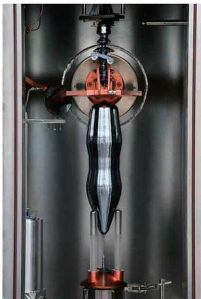
図4 FZ (浮遊帯域) 法で引き上げられた濃縮度 99.99%、質量 5 kg の  $^{28}\text{Si}$  同位体濃縮単結晶。<sup>20, 21)</sup>
