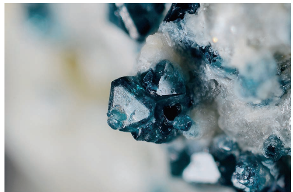
図9 スピネルの結晶。 \text{MgAl}_2\text{O}_4 組成で立方晶系の鉱物。写真は埼玉県秩父市秩父鉱山から見つかった青色の八面体結晶。
