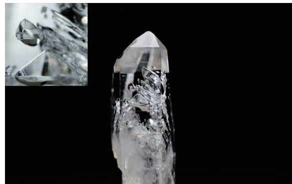
図2 石英の結晶（通称：水晶）。 \text{SiO}_2 組成で三方晶系の鉱物。結晶内に取り込まれた気体が結晶面で囲まれており、このようなものを「負晶（ふしょう）：Negative crystal」という。この水晶は島根県隠岐の島 焼火山で見つけた。
