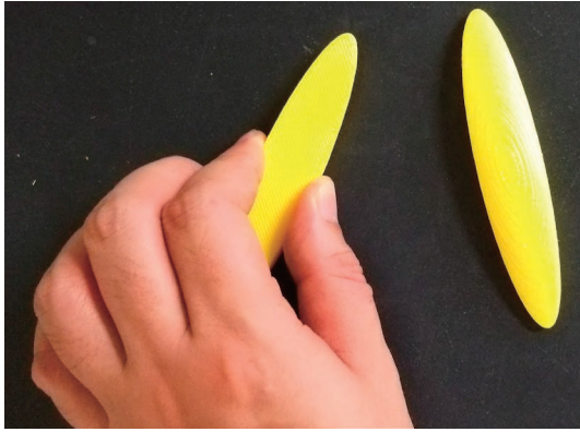
図8 3Dプリンターで印刷したラトルバック。剛体の運動を確かめることができる。
