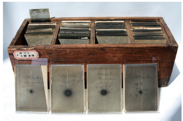
図1 理化学研究所資料室に保管されていた、西川正治によるX線回折写真乾板。一つ一つがメモの入ったパラフィン紙に包まれ、木箱に入れられた状態で保管されていた。
