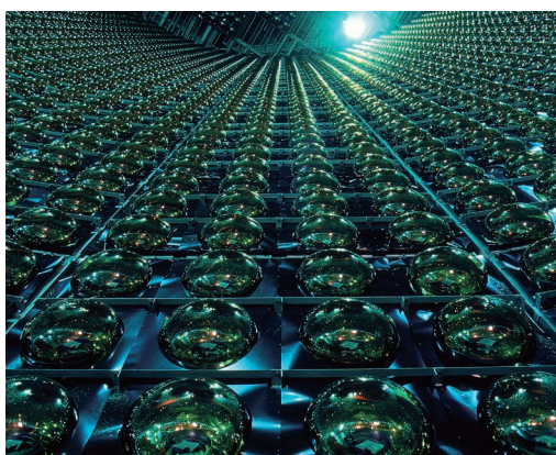
図5 スーパーカミオカンデ内部. 直径39.2 m, 高さ41.4 mの巨大水槽の内壁に並ぶ11,200本のR3600.
