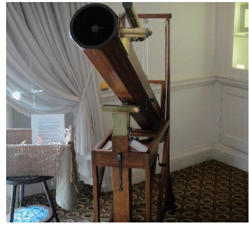
図2 ウィリアム・ハーシェルが天王星を発見した、自作の16 cm 反射望遠鏡。(複製, ウィリアム・ハーシェル博物館: 海部撮影)
