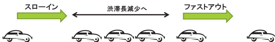
図7 スローイン・ファストアウトの概念. 渋滞領域への流入を減らし、流出をより増大させれば渋滞長は短くなってゆく.
