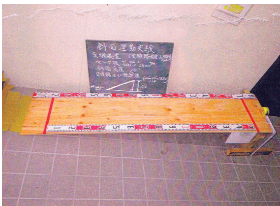
図4 加藤の斜面実験のセットアップ。家族に協力してもらい専用のスロープを製作した。
