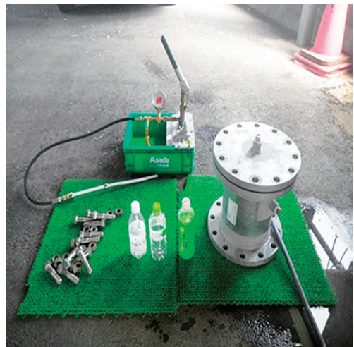
図5 加藤が構築した高圧チェンバー。近所の金物屋などをまわり、必要な部品を調達して製作した。
