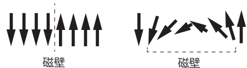
図4 厚さを持たない磁壁(左)と厚さを持つ通常の磁壁(右)。
