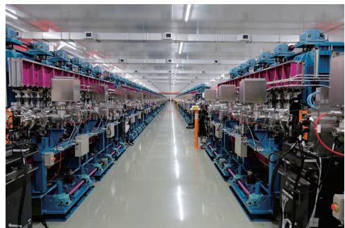
図2 SACLAのアンジュレータ。右側が最初に設置されたBL3。左側が2014年に設置されたBL2。
