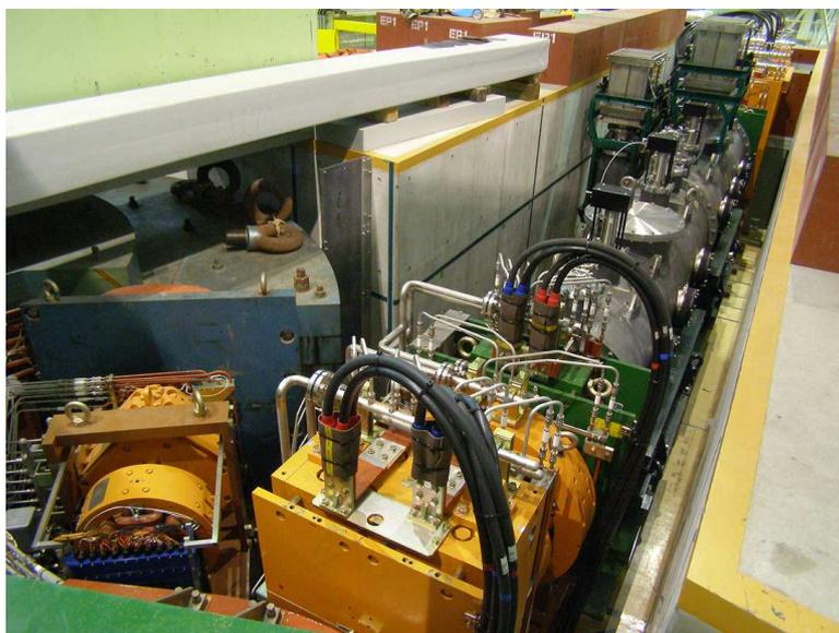
図 2.4: 第二段静電セパレータ。写真手前がビーム上流側であり、そこから黄色の収束電磁石 Q7、八極極電磁石 O2、六極極電磁石 S3、緑色の静電セパレータ用偏向電磁石 CM3 とあり、その奥に見えている銀色の装置が静電セパレータである。
