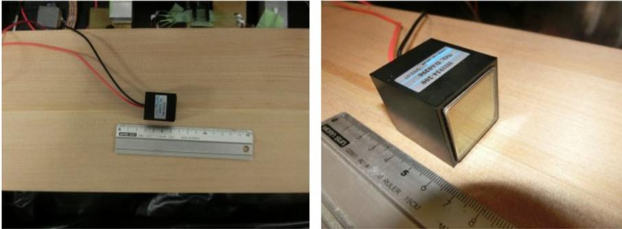
図 5.3: カウンターに使用した PMT。印加電圧-1300V で使用し、その際の Gain は  $3.48 \times 10^7$  である。
