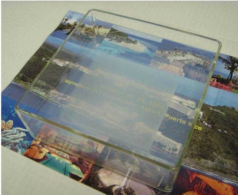
**図 25 フレーム構造法による低屈折率エアロゲル**
