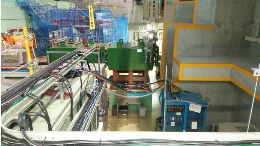
図 3.15 エリア内と Distributor をつなぐシンフレックスチューブ
