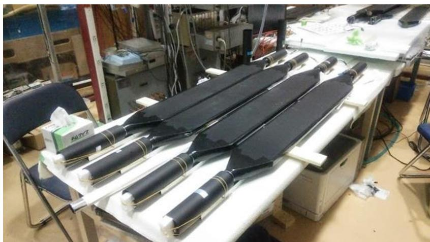
図 3.1 接着中の TOF2(直線型)
