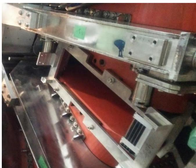
図 3.9 トロイダル磁石に設置された C3 および C4 の固定ベース金具
