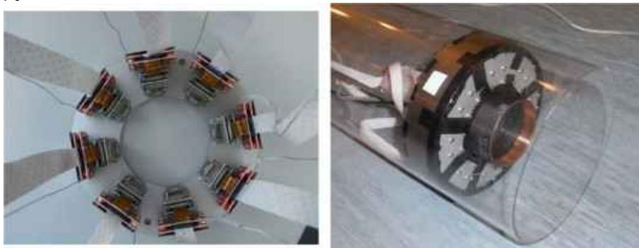
図 8. MRI-PET のための試作ガントリー。このガントリーは 8 個の MPPC ベースの PET モジュールで構成され、チタンとアルミニウムで作られている。
